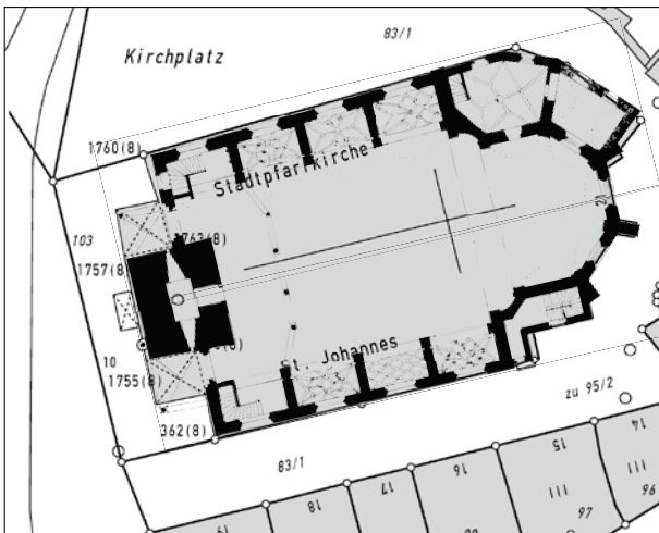
Abbildung 5: Die Überlagerung des zeitgenössischen Vermessungsplans auf die kunsthistorische Grundrißaufnahme der Pfarrkirche zeigt die größere Genauigkeit der Vermessung; die Außenmauer des westlichen Seitenschiffes läuft nicht parallel zur östlichen Seitenschiffesmauer und der Eingangsbereich im Westen des Turmes ist nicht im rechten Winkel auf die Kirchenachse ausgebildet.
