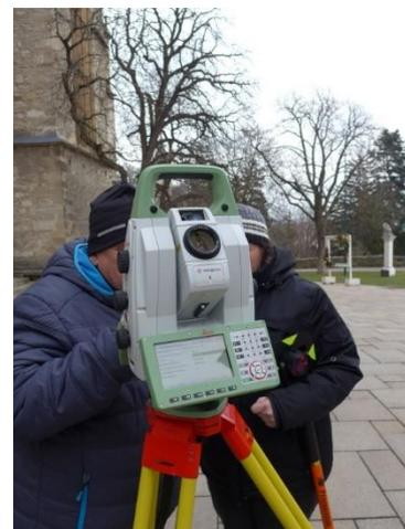
**Abb.4:** Mödlinger Karner, Detailvermessung zur Bestandsaufnahme
