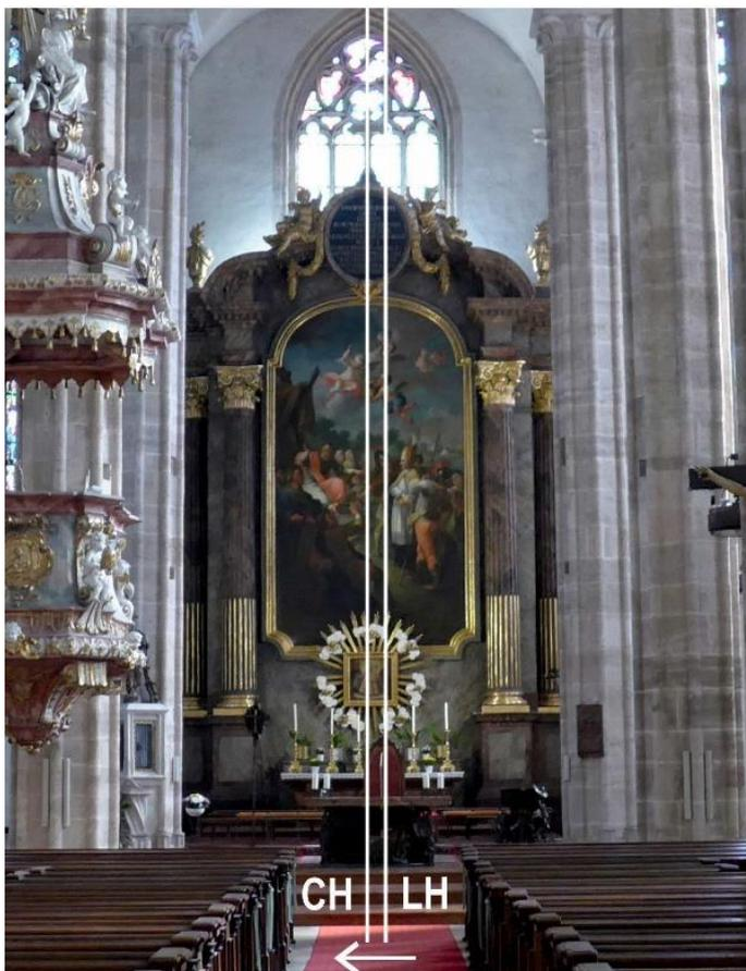
**Abb.14:** Mödling, Pfarrkirche St. Othmar mit Achsknick nach Norden (Knickwinkel ca.  $1.02^\circ$ )
