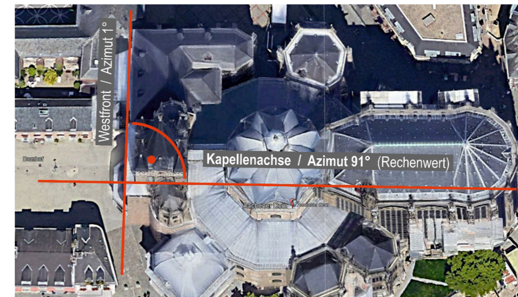
Abb. 1: Aachen, Pfalzkapelle. Orientierung der Kapellenachse, die als Senkrechte auf die Westfront des Kapellenvorbaus angenommen wird (Azimut 91^\circ ).
