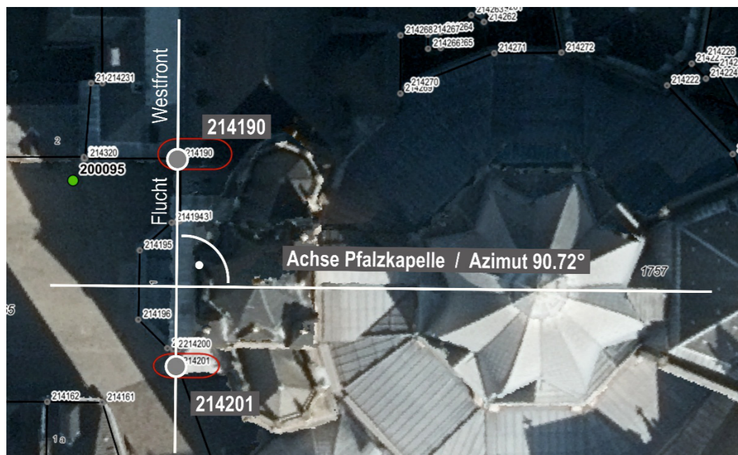
Abb.6: Aachen, Pfalzkapelle Westfront („erster Ansatz“). Es wird angenommen, dass die Achse der Pfalzkapelle darauf senkrecht steht (Berechnung Tabelle 4 , Azimut 90.72°)
