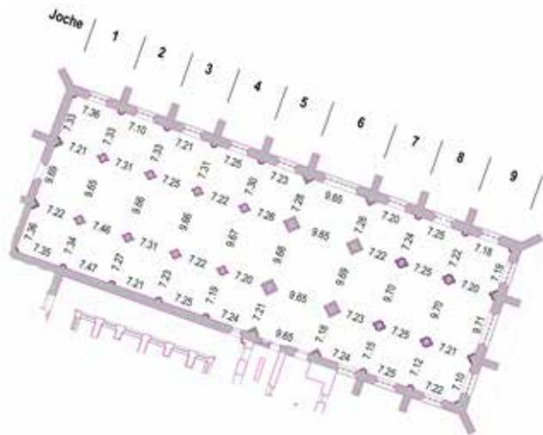
Abb. 15: Münster Neuberg, Pfeilerraster Ausführung. Die Abmessungen wurden aus Plan Abb.6 (oben) mittels CAD im metrischen System graphisch erfasst.<sup>29</sup>
