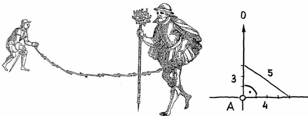
**Abb.55:** Längenmessung mit Messketten oder Messlatten, Absteckung des rechten Winkels durch Konstruktion mit dem pythagoräischen Dreieck
