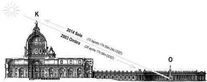
Fig. 16: Sezione longitudinale della Basilica di San Pietro (K - croce sulla cupola) – Piazza San Pietro (O - obelisco) con linea d'ombra su cui basano i dati dell'osservazione astronomica, per tracciare le linee di riferimento per l'orientamento verso nord del disegno (fig. 9).
