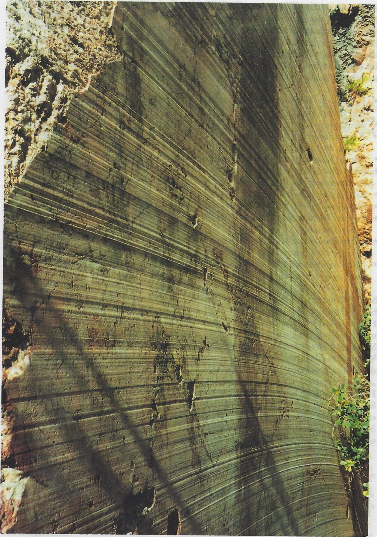
Abb. 3: Marmorsteinbruch Engelsberg 1995, Riffelung der Schnittflächen durch den Abbau mittels Seilsäge. – Photo: Erwin REIDINGER.
